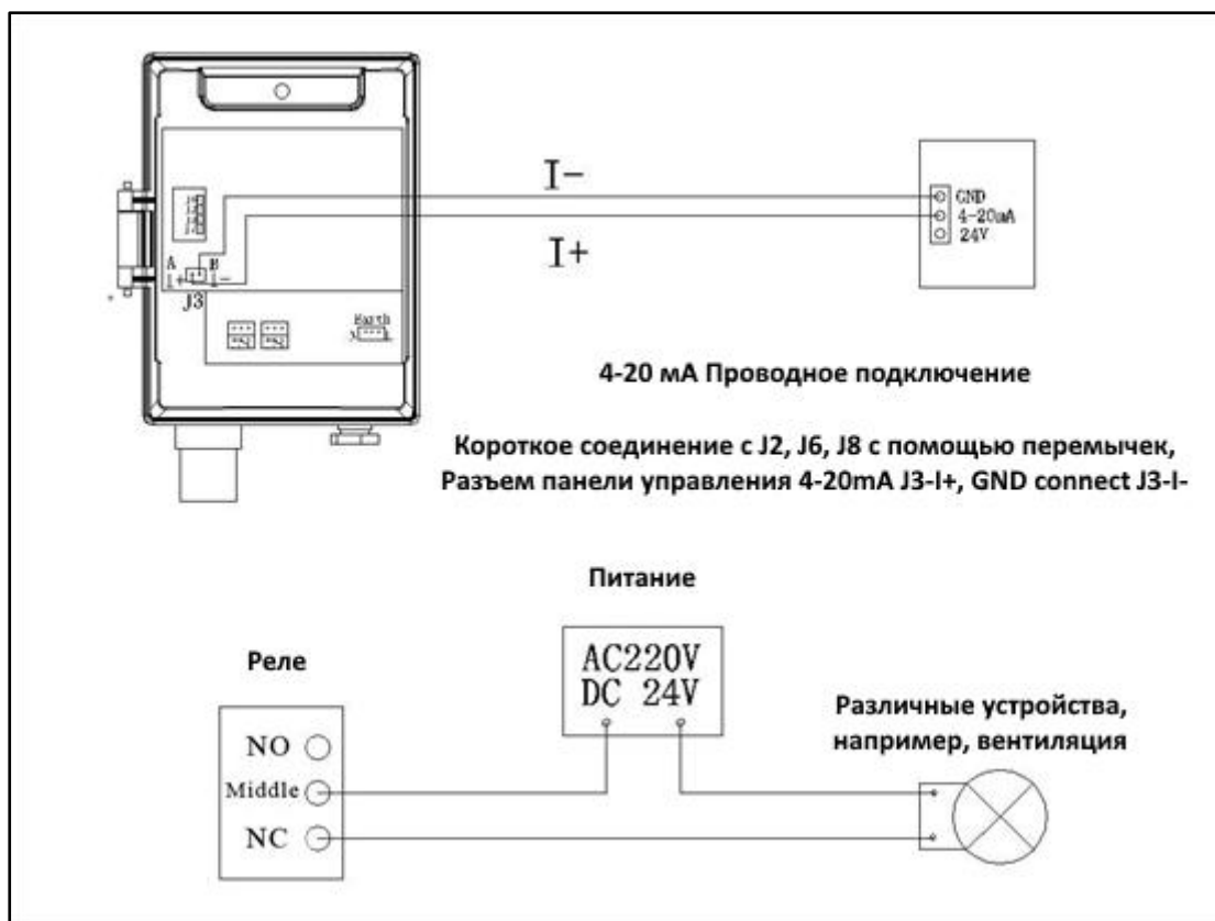
Рис. 3.1. Проводное соединение 4-20мА
